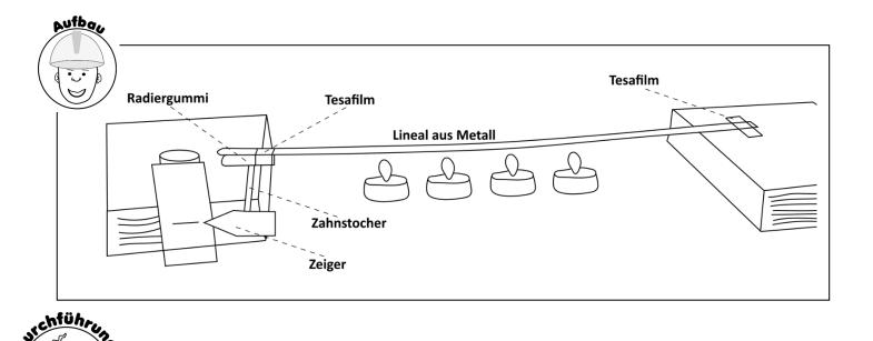
Im folgenden Experiment werden vier Teelichter unter ein Alu-Lineal (*Brücke*) gestellt. Auf der einen Seite der Brücke ist das Lineal fest verklebt mit dem Buch (*dem Brückenpfeiler*). Auf der anderen Seite liegt die Brücke auf einen beweglichen Holzstiel (*der Verbindungsrolle*). Zwischen Holzstiel und Lineal befindet sich ein Radiergummi zur Unterstützung der Rotation. Am Ende des Holzstiels sorgt ein Pfeil vor einer Skala für die genaue Beobachtung der Ausdehnung der Brücke.
